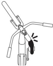
Beim Lenken besteht das Risiko, mit dem Fuß das Vorderrad zu berühren. Wenn du den Lenker bei sehr geringen Geschwindigkeiten einschlägst, kann es passieren, dass du das Vorderrad oder das Schutzblech mit dem Fuß berührst. Tritt bei langsamen Geschwindigkeiten und bei eingeschlagenem Lenker nicht in die Pedale.
