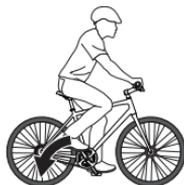
Die höchste Bremskraft wird erreicht, wenn die Kurbelarme beim Betätigen der Bremse waagrecht stehen. Da sich die Kurbel etwas dreht, bevor die Bremse das Fahrrad tatsächlich abbremst, sollte der hintere Kurbelarm zu Beginn des Bremsvorgangs etwas über der Waagerechten liegen.
